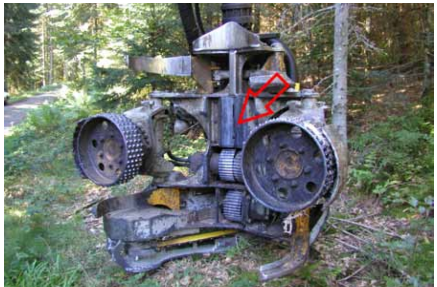
Abb. 1: Vollernterkopf mit Längenmessrad
