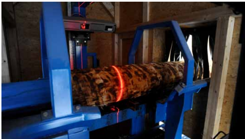
Abb. 3: 3D-Rundholzmessanlage, Messung mit „variablen Winkeln“ (Foto: Microtec)
