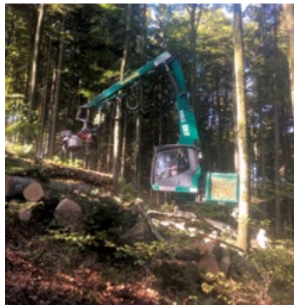
Im steilen Gelände bei 15m Kranreichweite volle Leistung
