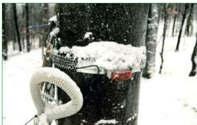
Abbildung 4: Mit elektronischen Dendrometern sind hochempfindliche Messungen der Umfangsänderungen in so kurzen Zeitintervallen möglich, dass nicht nur der Jahreszuwachs sondern auch das Quellen und Schwinden der Bäume im Tagesverlauf erkannt wird.
