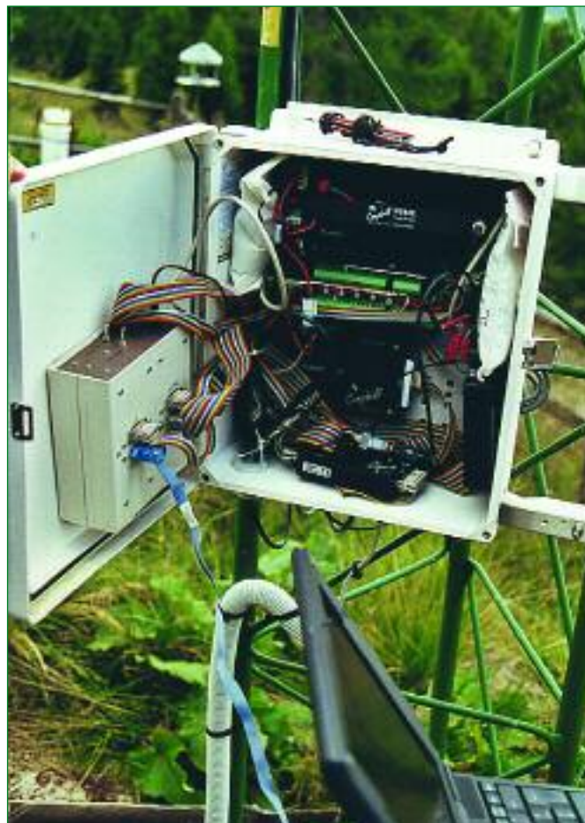
Abbildung 5 a und b: Auf Intensivbeobachtungsflächen (hier bei Murau) konnten mit finanzieller Unterstützung der Europäischen Kommission im Rahmen von Forest Focus automatische registrierende Klimamessstationen eingerichtet werden.
