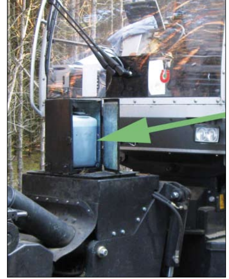
Abb. 6: Behälteraufbau für die Myzelsuspension am Harvester
