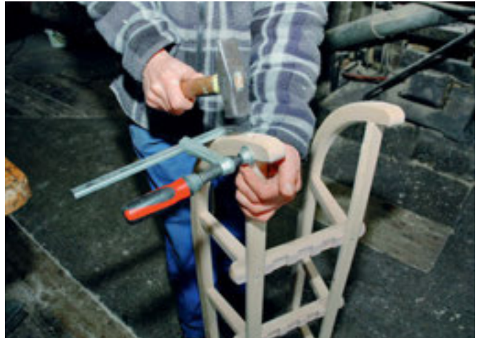
Die äussersten Lättli werden mit einem Nagel fixiert.
