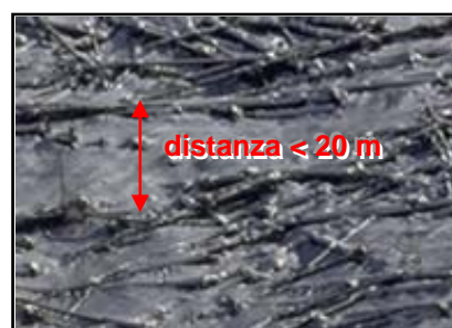
Figura 5: Distanza massima tra elementi che, tenendo conto della loro altezza utile, potrebbero essere ritenuti come «opere di protezione» (zona non sgomberata a Disentis (GR) durante l'inverno 1998/99).
