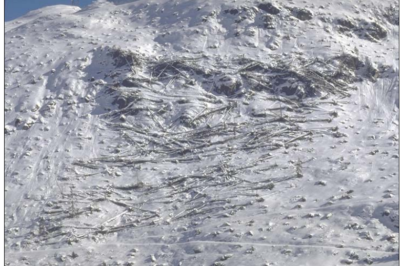
Abbildung 8: WSL-Versuchsfläche bei Disentis (1400–1500 m ü.M.) am 25.2.1999 (9 Jahre nach Vivian) mit einer Schneehöhe von 150 cm. Im Mittel hatten die Stämme der belassenen Teilfläche (Bildmitte) eine Wirkhöhe von knapp 120 cm. (Foto: W. Frey, WSL)
