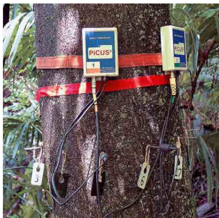
Enregistrement de pourriture de cœur et de fissures internes à l'aide du tomographe: premiers tests sur des ailantes avec le tomographe acoustique «Picus» (Argus Electronic GmbH Rostock) à Claro (TI). A gauche, le tomogramme montre les fissures internes grâce à la fonction «Crack-Detect»: traits jaunes = fissures, zones brunes = bois dur, zones bleu-violet = bois endommagé. Au milieu, les capteurs acoustiques posés sur l'ailante examiné à Claro. A droite, l'installation sur le terrain.
