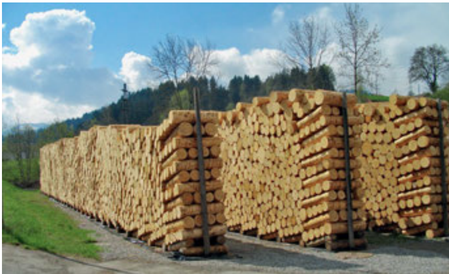
Préséchage des troncs destinés à la production de laine de bois, sur le site de l'entreprise.
