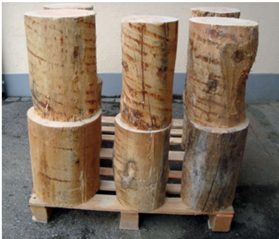
Bois brut pour la production de laine de bois. De g. à d.: qualité A: clair, fibre droite, presque sans nœuds; qualité B: clair, fibre légèrement torse, peu de nœuds; qualité C: non coloré, fibre torse, avec nœuds. L'exemple coloré, en bas à droite, est impropre à la production de laine de bois.
