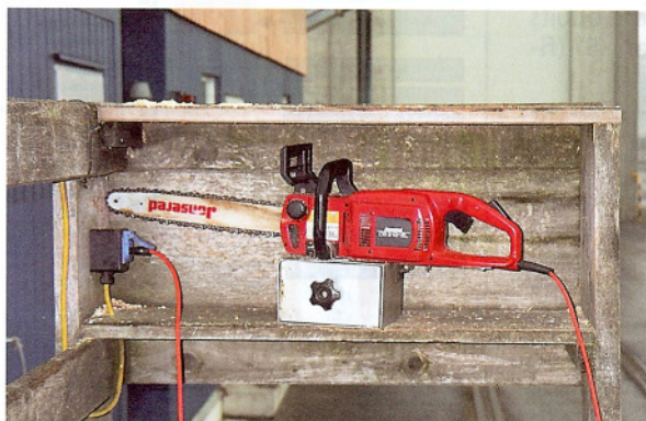
Tronçonneuse avec récipient permettant le prélèvement d'échantillons de bois ronds et de dosses/délinures. Elle est montée sur une rampe afin de faciliter le prélèvement d'échantillons.
