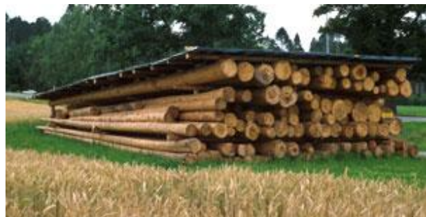
Cubierta de almacenamiento en seco en lugar bien ventilado.
