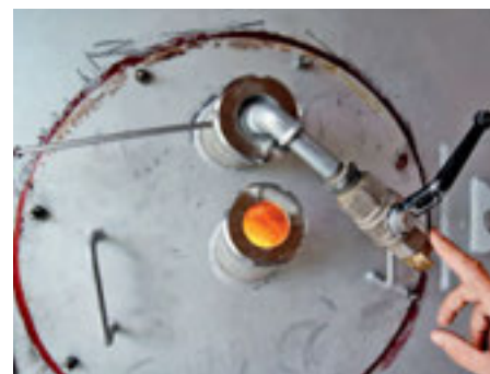
In der Brennkammer verglühen die giftigen Brenngase, die aus dem Verkohlungsprozess entstanden sind.
