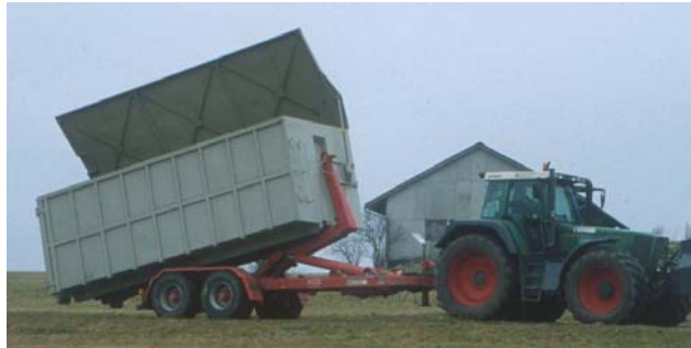
Abbildung 4: Landwirtschaftlicher Schlepper Fendt Vario 926 mit Lkw-Wechselcontainer auf Spezialanhänger
