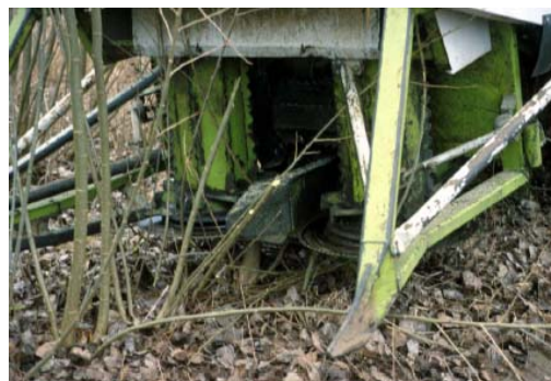
Abbildung 2: Schneidevorsatz mit gegenläufig rotierenden, gezahnten Förderwalzen sowie gegenläufig rotierenden Sägeblättern (jeweils getrennt regulierbar).
