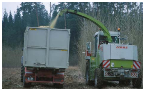
Abbildung 3: Beerntung auf der Fläche: Lkw-Container auf Spezialanhänger; Claas Jaguar (mit schmaler Bereifung)
