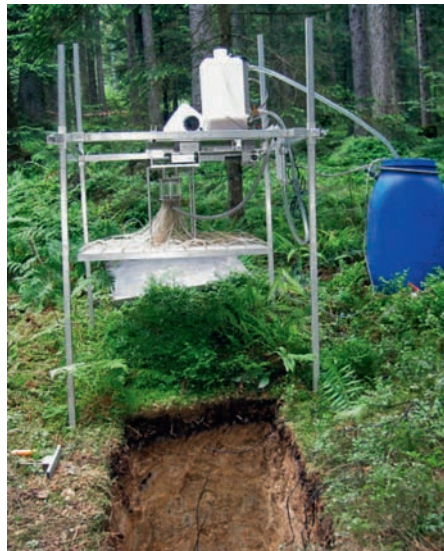
Abbildung 2: Versuchsaufbau mit Regensimulator und Sonden für die Wassergehaltmessungen im Boden
