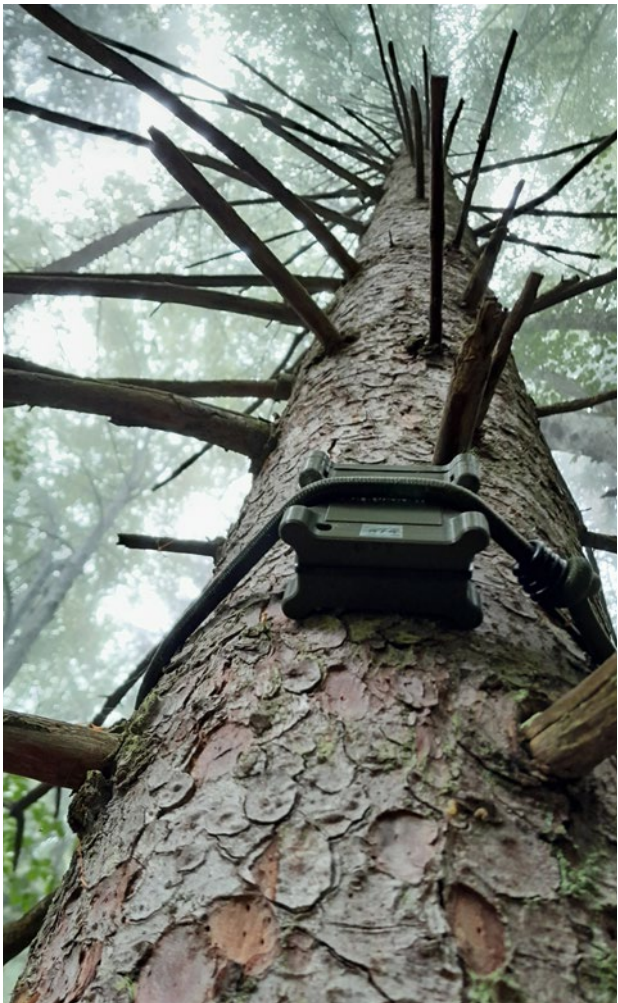
Akustische Datenlogger sind hier in Gehäusen am Baumstamm installiert. Der Brusthöhendurchmesser (BHD) der Bäume sollte möglichst gering sein, um Abschirmungseffekte des Schalls zu reduzieren und die Mikrofone, die Schallwellen aus allen Richtungen aufnehmen, optimal zu nutzen.
