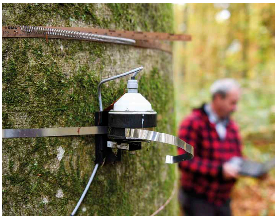
9 Eine Buche mit Permanent-Umfangmaßband sowie Dendrometer zur Beobachtung des Wachstums. Das Dendrometer wird gerade von einem Mitarbeiter der LWF kontrolliert
