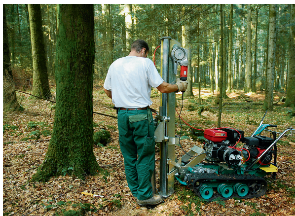
Figure 1: Prélèvement de racines fines à l'aide d'une tarière HUMAX.
