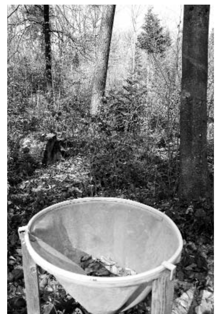
Abb. 4: Streusammler auf einer Fläche der Langfristigen Waldökosystem-Forschung der WSL. Wissenschaftler analysieren später im Labor die Menge und Zusammensetzung der Nährstoffe in den Blättern und Nadeln. Foto: Reinhard Lässig
