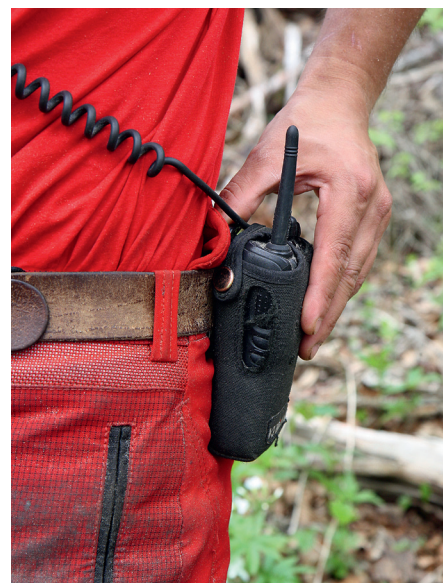
L'émetteur-récepteur se porte à la ceinture, et l'on prend soin de cacher le câble sous les habits pour qu'il ne risque pas de s'accrocher.
