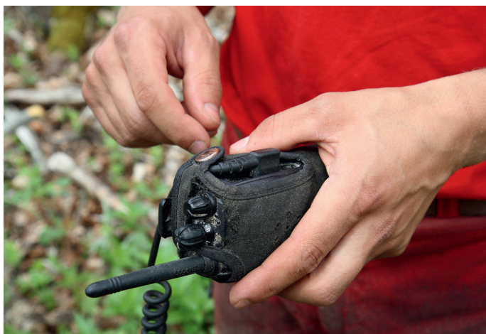
La garniture d'écoute Savox est amovible et se clipse dans le protège-ouïe.
