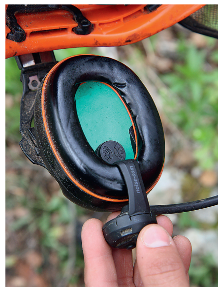
Si le câble est immobilisé habilement, il exerce moins de traction sur la fiche. Les étuis se sont avérés très robustes.
