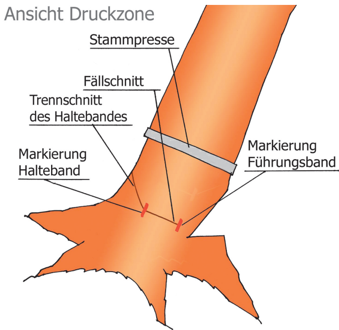
Ansicht Druckzone. Fällschnitt entsprechend Bandbreite tief.
