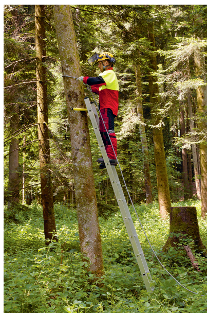
Echelle avec étriers de sécurité.
