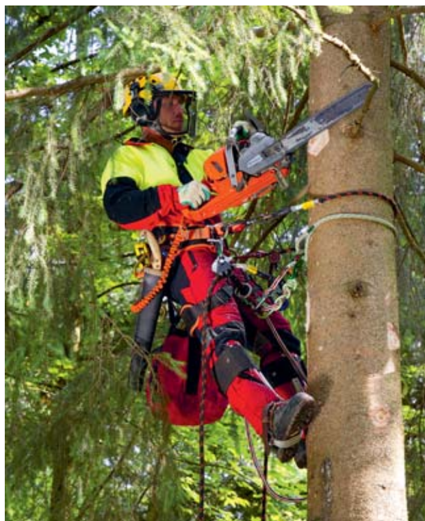
Travaux avec la tronçonneuse: double sécurité avec protection contre le risque de sectionnement.
