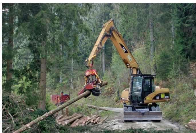
Façonnage rationalisé, au bord de la route forestière, à l'aide du processeur. Les chokers étant télécommandés, le machiniste n'a plus besoin de descendre décrocher les arbres à la main.
