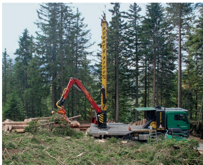
Engin combiné câble-grue et processeur Mounthy 4100 U, utilisé ici pour le façonnage, après débardage en aval par arbres entiers.
