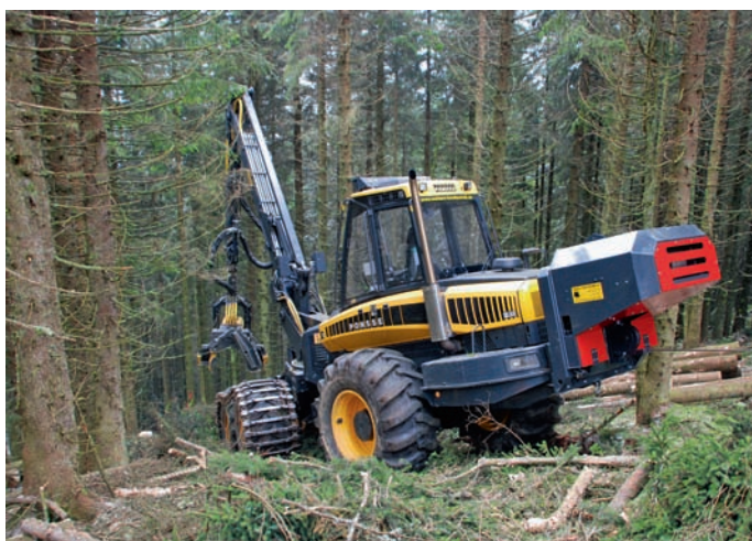
Récolte mécanisée sur terrain en forte pente: récolteuse à pneus Ponsse sur laquelle est monté un treuil de traction de Herzog Forsttechnik.
