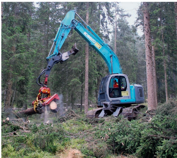
Récolteuse à chenilles avec treuil intégré permettant de câbler jusqu'à la machine les arbres se trouvant hors de portée de la grue. Les lignes de câble-grue pour le débardage peuvent ainsi être très espacées.
