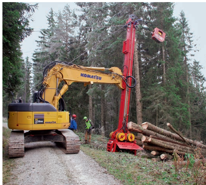
Le câble-grue mobile de Herzog Forsttechnik s'installe de manière simple et rapide. Il convient bien pour le débardage par arbres entiers et lorsque les lignes de câble sont peu espacées.
