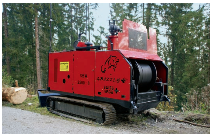
Treuil pour câbles-grues longue distance, encore un prototype de Herzog Forsttechnik. Particularités: l'écartement réglable des chenilles et l'entrée du câble par le haut de la machine.
