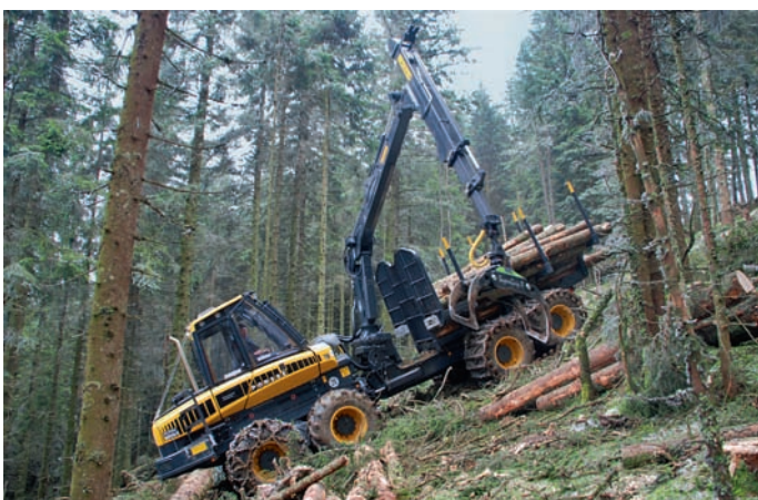
Le treuil de traction permet au porteur de travailler en sécurité même sur forte pente.
