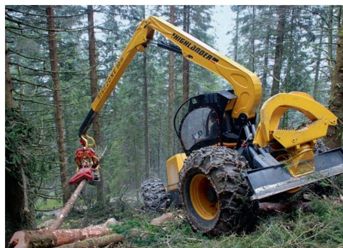
La récolteuse Highlander de la firme autrichienne Konrad Forsttechnik est à l'aise même sur des pentes très abruptes. Elle est équipée d'un treuil et d'une pince.
