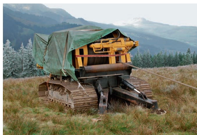
Treuil de traction de Herzog Forsttechnik monté sur chenilles. Le tout pèse 18 t et peut servir d'ancrage amont ou aval.
