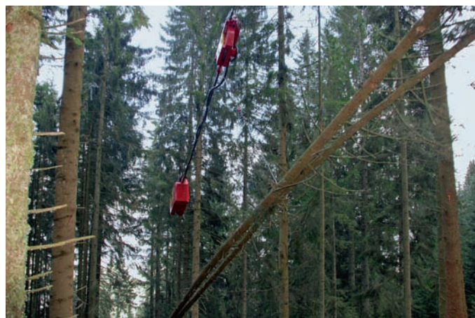
Grâce à ce double chariot, une nouveauté de Herzog Forsttechnik, il est possible d'évacuer vers la vallée par câble-grue des arbres entiers.
