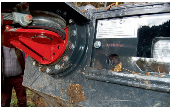
Une caméra (cercle) permet au machiniste de voir le terrain; une autre, dans le carter du treuil, filme l'enroulement du câble.
