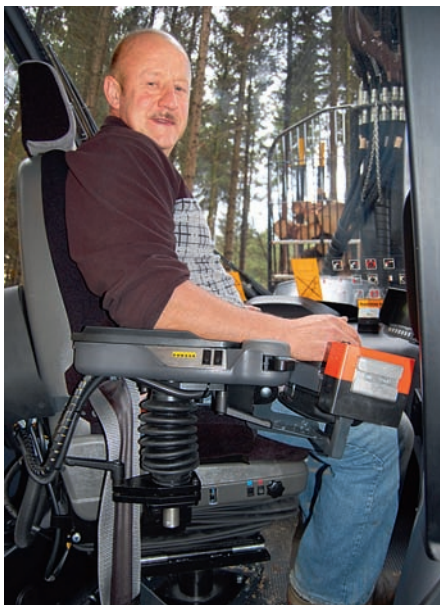
Le siège du machiniste garde toujours une assise horizontale.
