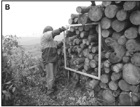
Abbildung 9: Bestimmen des Flächenanteils der Kronenfüsse an der gesamten Stirnfläche des Polters. Diese Bestimmung kann stichprobenartig mittels eines Holzrahmens von 1x1m Seitenlänge erfolgen.
