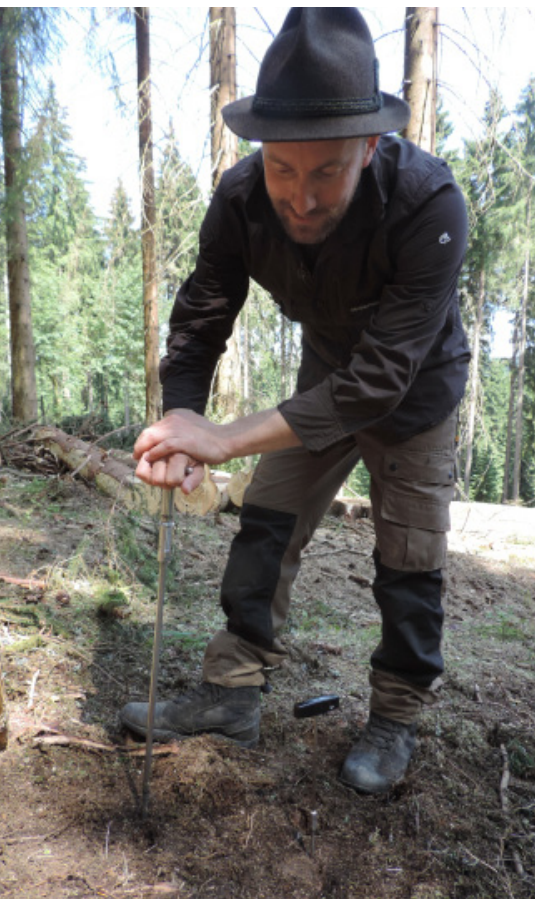
Abb. 4: Der Autor beim Einsatz der Flügelsonde
