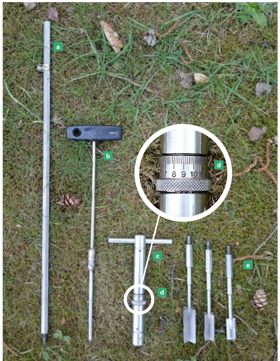
Abb. 2: Leichter Scherfestigkeitsmesser (Flügelsonde „push-in-Typ“). a: Verlängerungsstange; b: Nadel zum Vorstechen des Messlochs; c: Messgerät für Drehmoment; d: Schleppzeiger; e: verschiedene Flügel
