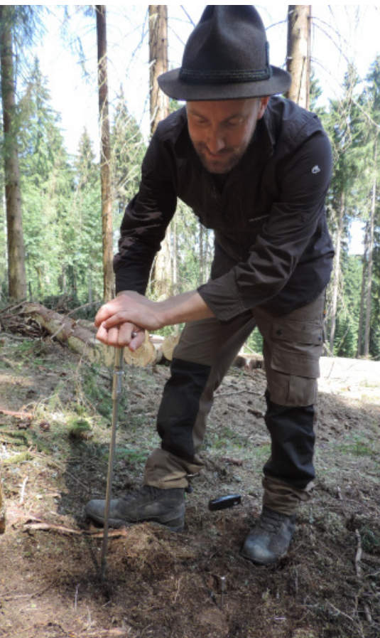
Abb. 4: Der Autor beim Einsatz der Flügelsonde
