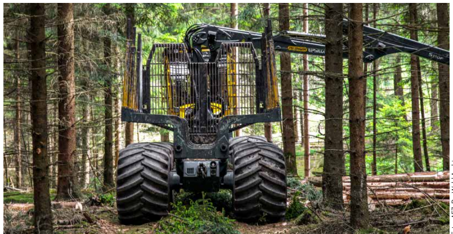
Abb. 1: Fahrbewegungen von Forstmaschinen sind im Waldbestand auf die Rückegassen beschränkt. Doch auch hier können die Maschinen Bodenschäden verursachen.
