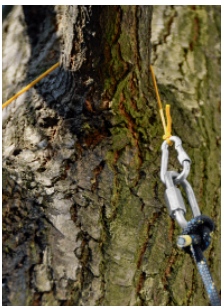
La corde T (en bas à droite) est tirée par-dessus la branche à l'aide de la cordelette à lancer.
