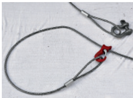
Le câble de rallonge en acier avec crochet coulissant (en bas) est fixé au câble du treuil avec une manille (en haut).
