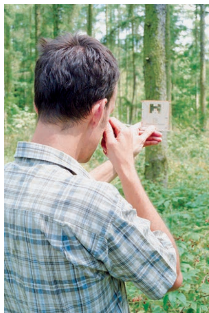
Mit etwas Übung ist die Winkelzählprobe auch für Laien einfach durchzuführen (der Baum im Bild ist breiter als das Zählblättchen mit der Zählzahl 1 und wird deshalb gezählt)
