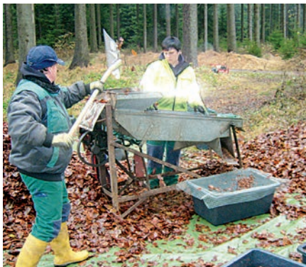
Maschinelle Reinigung von Rotbuchen-Saatgut vor dessen Zertifizierung nach Forstvermehrungsgutgesetz
