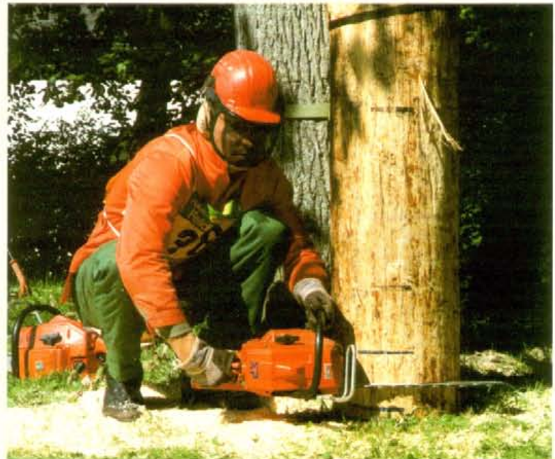
Die Folgen eines Fremdkörperkontaktes sind bei kantengeschliffenen Ketten deutlich geringer
