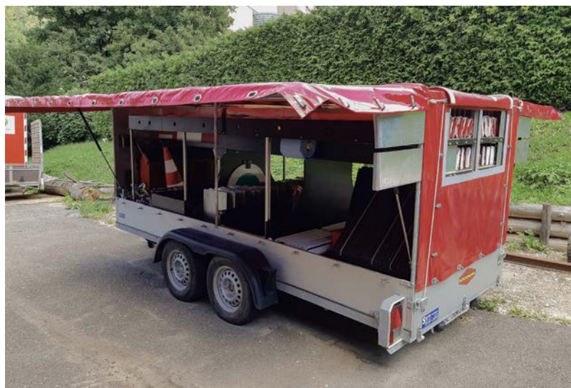
Auf dem praktischen PW-Anhänger ist alles nötige Signalisations- und Absperrmaterial gelagert.
