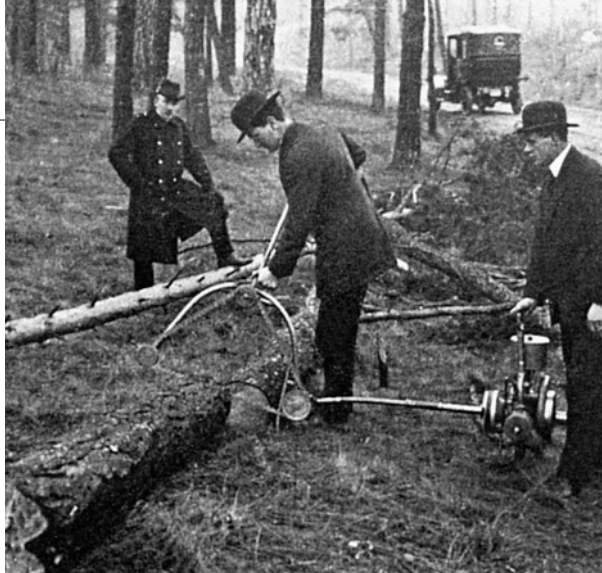
Bild 4: Die Dolmar von 1929 stand auf verstellbaren Füßen, war aber – mit Zusatzgerät – auch fahrbar. Die Bedienung konnte auch durch einen Mann erfolgen.
