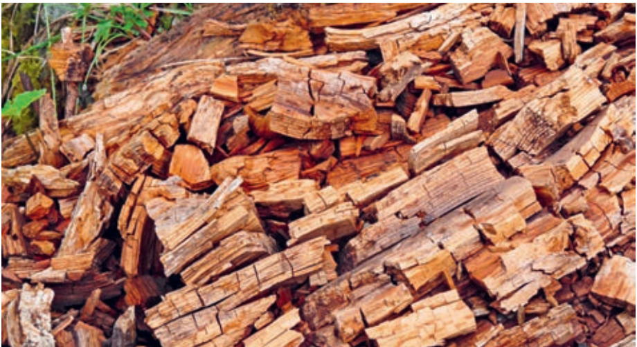
Abb. 2. Braunfäule mit typisch würfeliger Struktur. Bild: Thomas Reich, WSL
